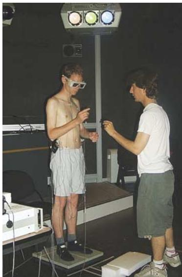
Figure 1. Installation du sujet en station debout sur la plate-forme de force, équipé des markers optiques et des lunettes stéréo.
