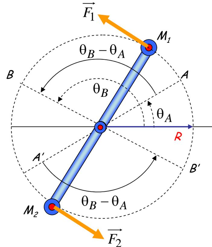
Le travail d'un couple dont le plan est perpendiculaire à l'axe de rotation est égal au produit de son moment par l'angle de rotation, exprimé en radian.
