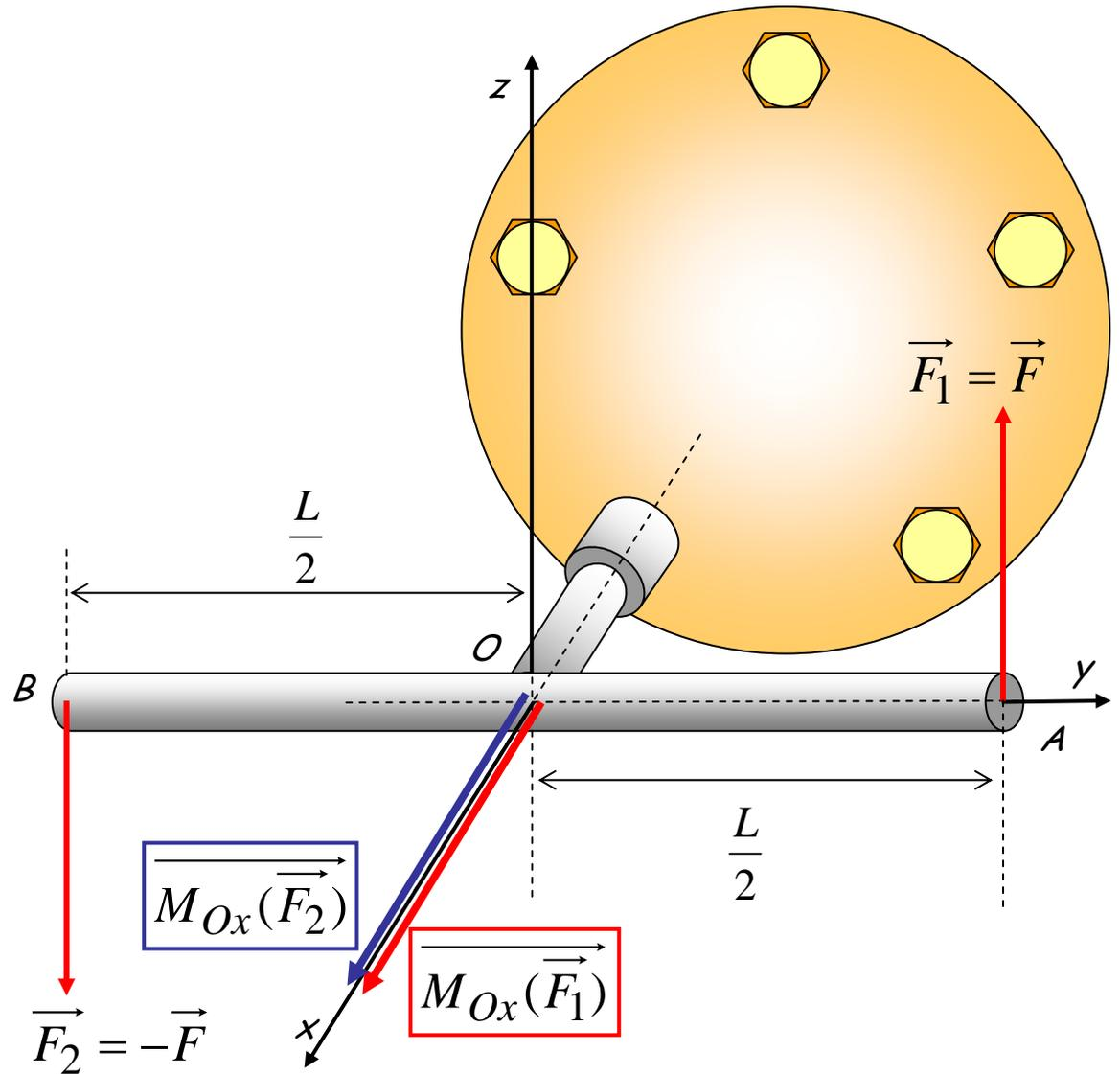
L'application d'un couple à un solide a généralement pour effet de le mettre en rotation
