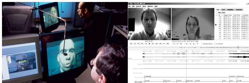
Figure 1 : Dispositif de capture croisée et étiquetage des données dans ELAN.
