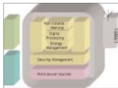
> Fig. 1 : structure fonctionnelle d'un microsystème sans contact.
