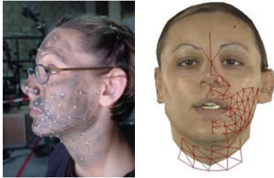
Figure 1. Gauche: Disposition des points caractéristiques utilisés pendant la capture des mouvements. Droite: Le clone virtuel 3D de la lectrice.
