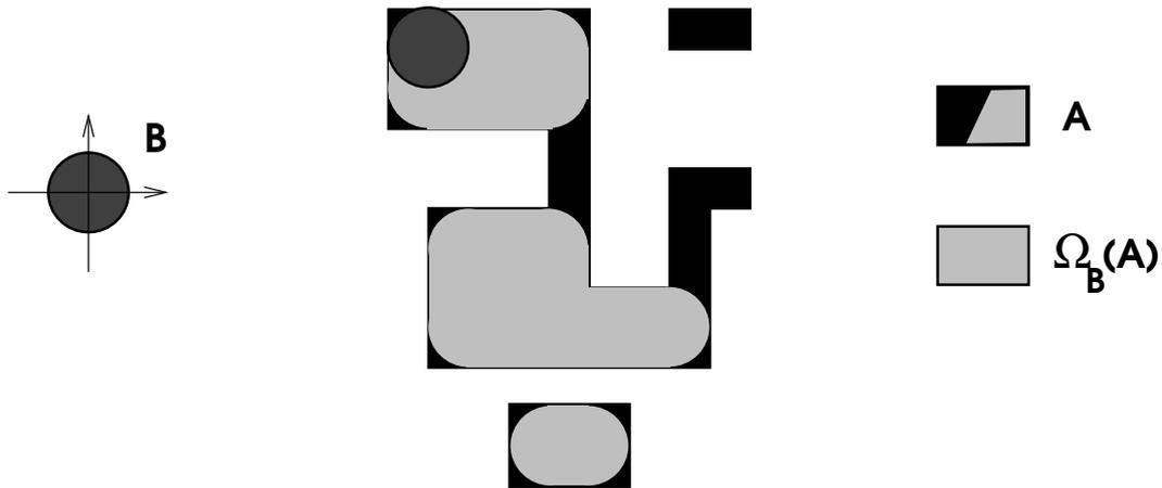
fermeture : espace non balayé par l'élément structurant B lorsqu'il est inclus entièrement dans le fond A<sup>c</sup>
