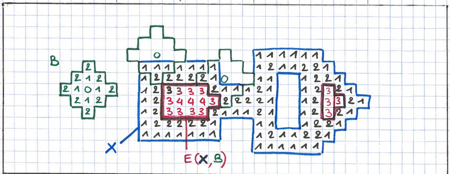
ouverture : espace balayé par l'élément structurant B lorsqu'il est inclus entièrement dans l'objet A
