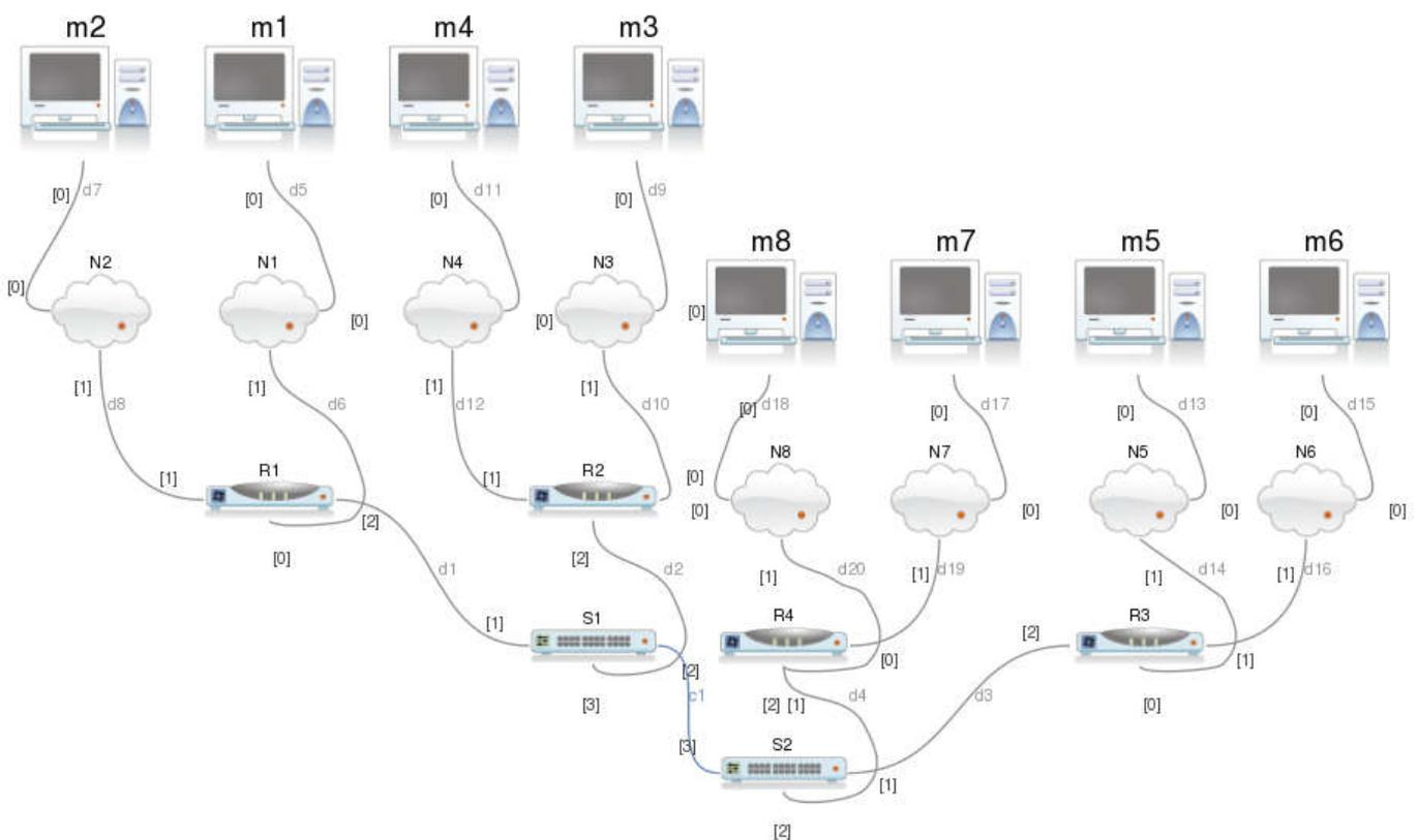
Pour atteindre chacun des réseaux il est nécessaire de préciser le routeur à utiliser (*gateway*)
