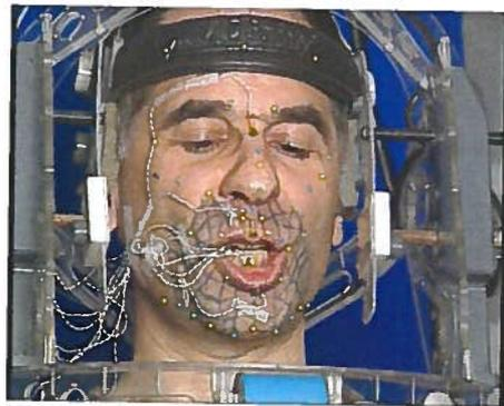
FIGURE 6. — Exemple d'une image issue de la vidéo enregistrée simultanément avec l'articulographe. On distingue les éléments du casque qui supporte les bobines électromagnétiques émettrices, les fils qui relient les bobines réceptrices au dispositif d'acquisition, un certain nombre de billes colorées collées sur le visage du sujet, et des traits tracés pour permettre de mieux suivre les mouvements.
