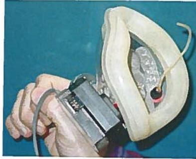
FIGURE 2. — Masque pneumotachographique de Rothenberg : la mesure de débit se fait par la mesure de la différence de pression de part et d'autre de la grille calibrée à travers de laquelle s'écoule le flux d'air lorsque le locuteur applique le masque sur le visage. On distingue également le tuyau qui est inséré dans la bouche du locuteur pour mesurer la pression buccale.
